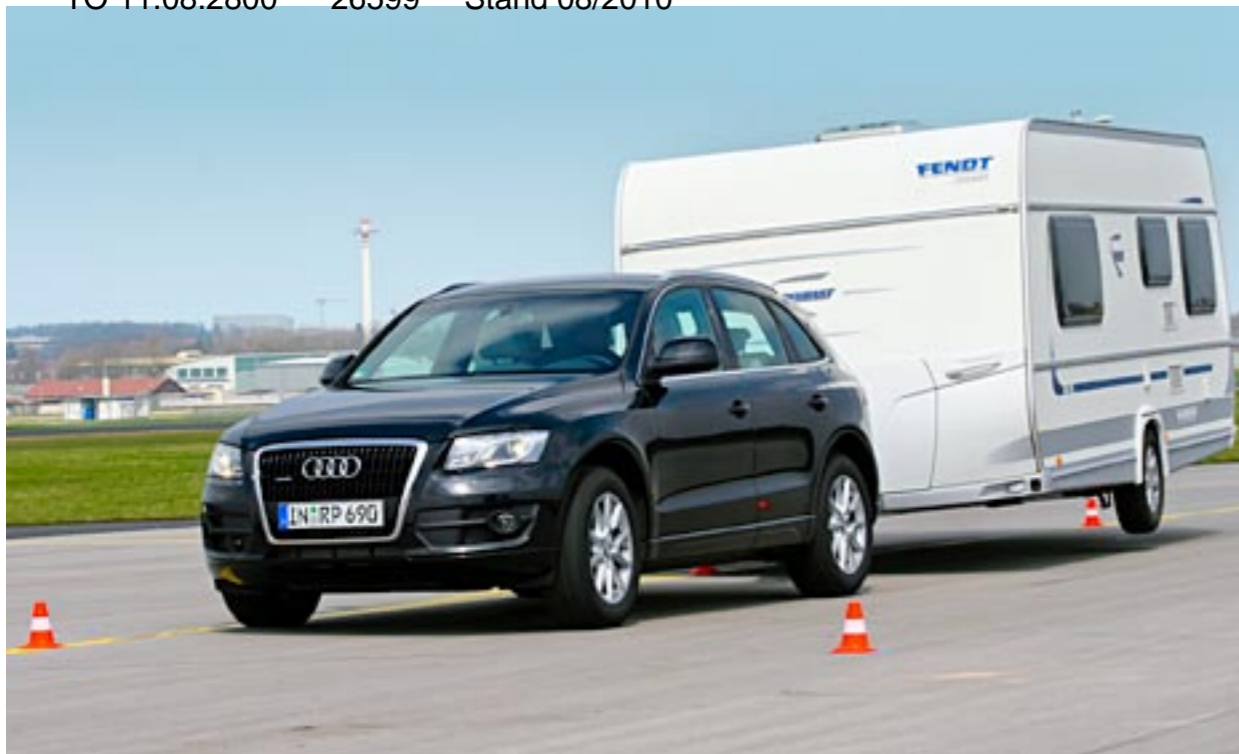
Abgehoben: Der Ausweichtest simuliert plötzliches Ausweichen vor einem Hindernis und anschließendes Einscheren. Der schwere Audi Q5 meistert den Pylonenparcours behäbig mit maximal nur 75 km/h
