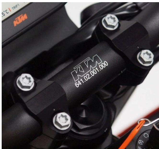
Macht das Schrauben leichter: Innentorx und Außensechskant an einem Schraubenkopf
