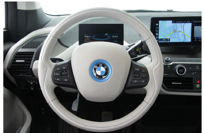
Griffiges Lenkrad mit direkter Lenkübersetzung im BMW; Joystick-Wählhebel rechts dahinter
