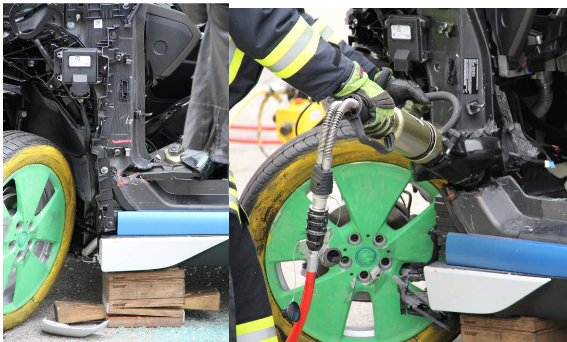
Abbildung 6: Durchtrennen der A-Säule mit hydraulischer Schere
