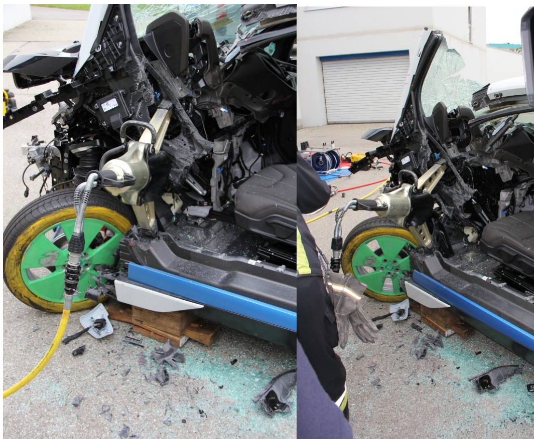
Abbildung 7: Aufspreizen des Fußraumes nach oben
