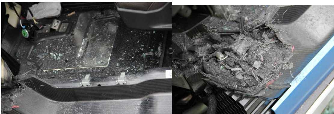
Abbildung 4: Staub und Partikelentstehung beim Schneiden des CFK Werkstoffes
