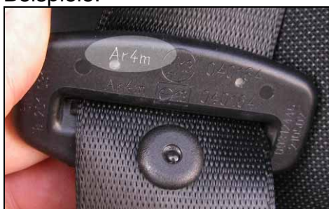
Abbildung 7: Gurt auf der Rückbank. Kennzeichnung an der Gurt-Zunge.
