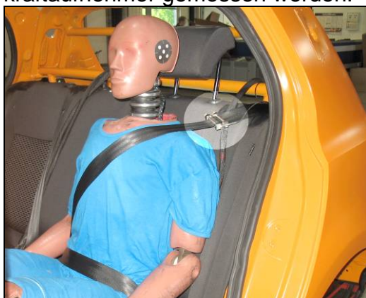
Abbildung 5: Messung der Gurtkraft mit Gurtkraftaufnehmer
