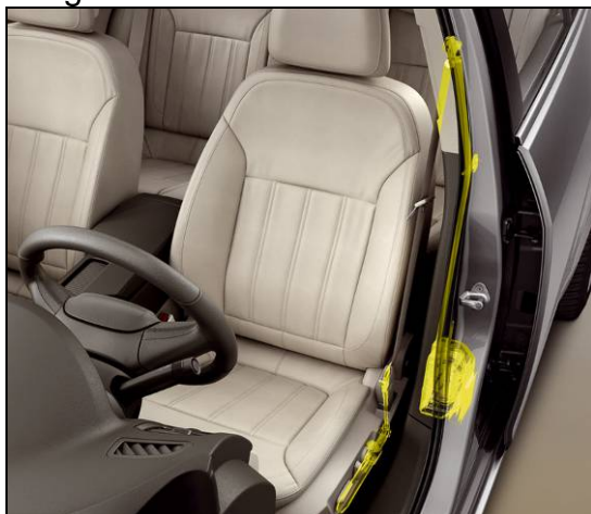
Abbildung 3: Doppelter Gurtstraffer im Opel Insignia (Quelle:Opel)
