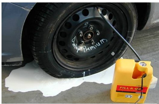
Austritt von latexhaltigem Dichtmittel
