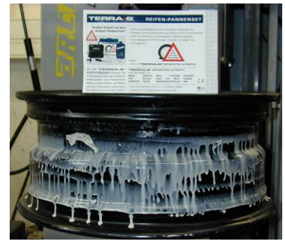
Felge mit Latexdichtmittel
