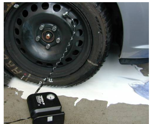
Dichtmittelaustritt bei Terra-S Standard
