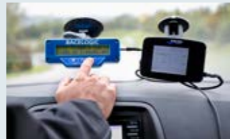
Messtechnik für Geschwindigkeit, Beschleunigung und Bremsweg
