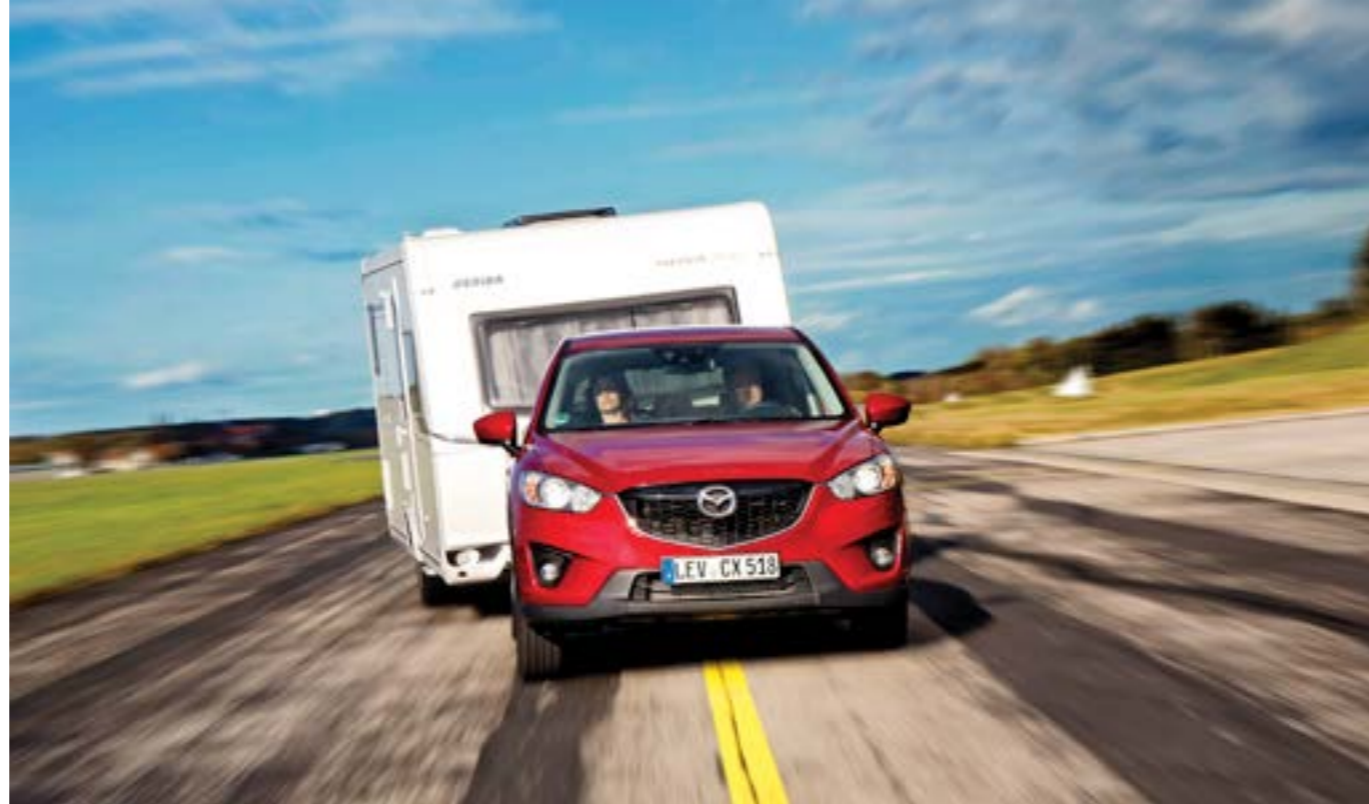
Den Pendelversuch, der eine Windböe oder Ausweichen bei hoher Geschwindigkeit simuliert, absolvierten alle vier Testwagen ähnlich gut
