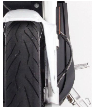
Einzelne Details sind nicht optimal gelöst, hier die Leitungslänge zur Vorderradbremse.
