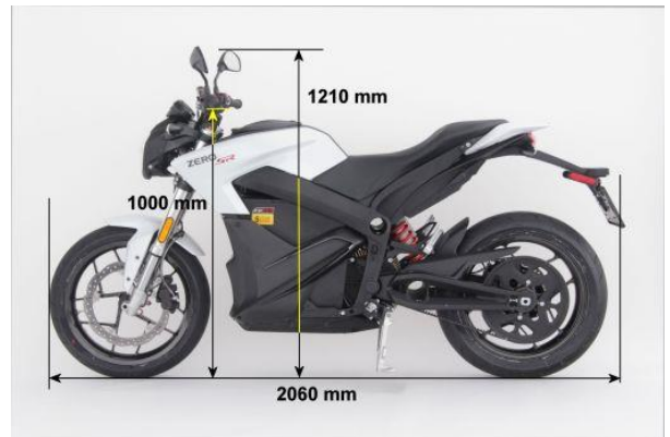
Das Gewicht von 190 kg sieht man der kompakten ZERO SR nicht an.
