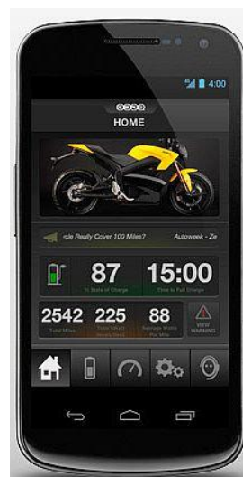
Mittels BT-Schnittstelle und App kann auf Daten und Einstellungen zugegriffen werden.
