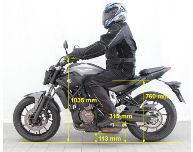
Die Positionen von Sitz, Lenker und Fußrasten ergeben für Menschen unterschiedlicher Größe eine angenehme Fahrhaltung.
