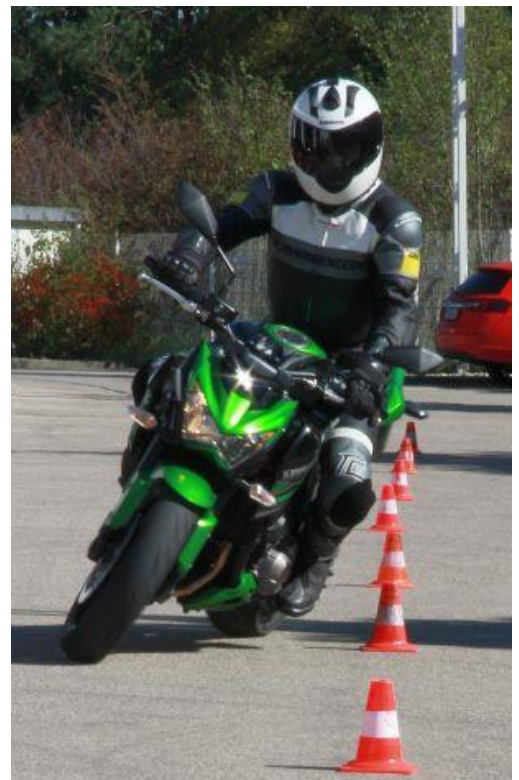
Wendigkeit der Z 800 leidet unter dem engen Lenkeinschlag.
