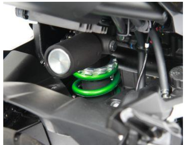
Kawasaki sieht vor, dass die Federbasis am Hinterrad von einem Händler eingestellt wird.
