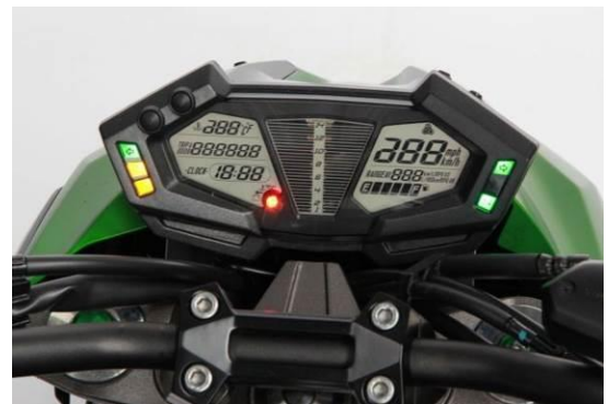
Das kompakte Display ist direkt vor dem Lenker weit unten angeordnet.
