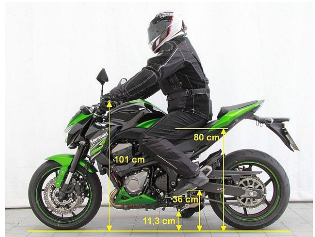
Die Positionen von Sitz, Lenker und Fußrasten ergeben für Menschen unterschiedlicher Größe eine angenehme Fahrhaltung.
