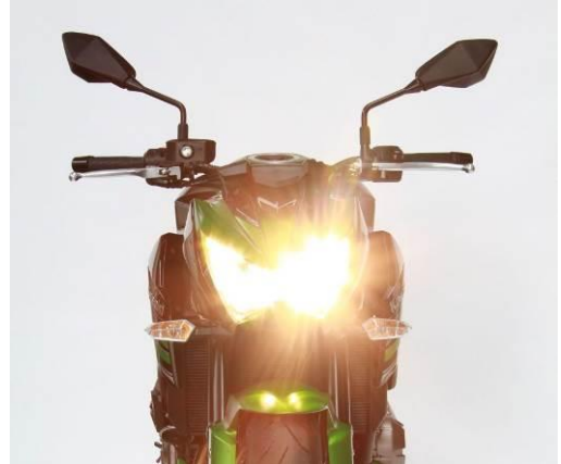
Die zwei Frontscheinwerfer mit H7-Lampen bringen gute Sicht und Sichtbarkeit.
