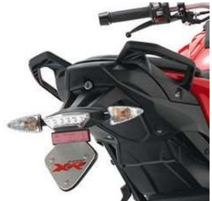
Auch in der Serienausstattung (ohne Gepäckbrücke) erleichtern massive Griffe am Heck das Rangieren.
