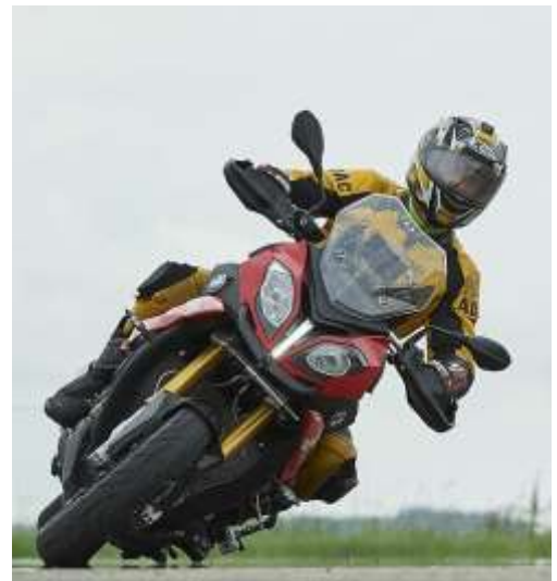
Das Sonderzubehör ABS Pro erlaubt starke Bremsungen selbst in hohen Schräglagen Bild: Uwe Rattay
