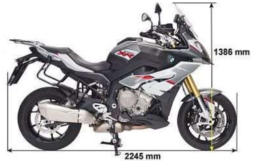
Die Abmessungen sind vergleichbar mit denen der Wettbewerber. Leicht ist die Maschine nur mit Serienausstattung.
