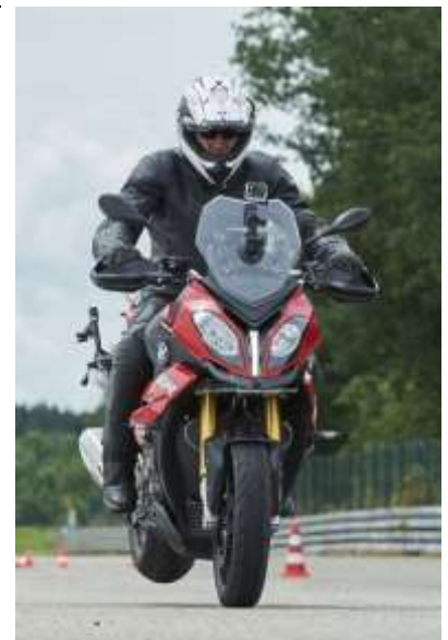
Nur in den Dynamic- Modi wird die S 1000 XR beim Bremsen etwas unruhig. Bild: Uwe Rattay
