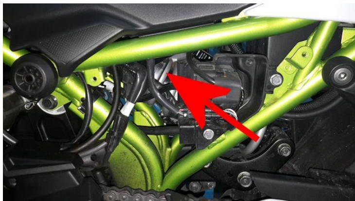
Gut versteckt und schlecht zugänglich: Einstellung für die Federbasis am Federbein.
