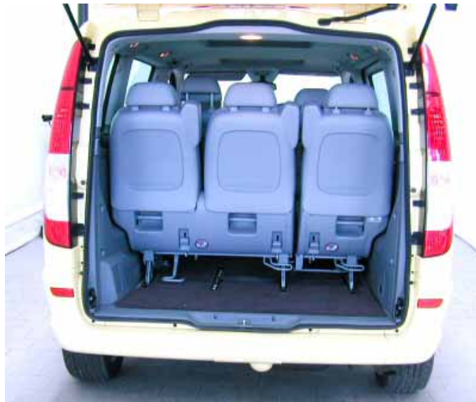
Auch bei voller Besetzung mit sieben Personen steht ein relativ großer Kofferraum von 400 l Volumen für das Gepäck zur Verfügung.
