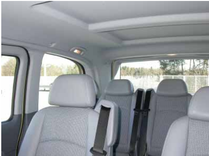
Trotz der versenkbaren Kopfstützen ist die Sicht aufgrund der breiten Dachsäulen eingeschränkt.
