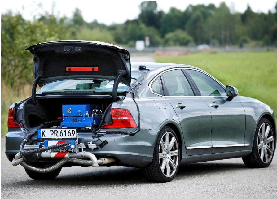
Abbildung 6: Testfahrzeug mit eingebauter PEMS-Messanlage
