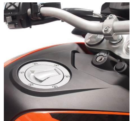
Beim Tanken bleibt der Deckel nicht stabil offen. Vorsicht: Bereits bei leichter Überfüllung des Tanks läuft Sprit aus dem Überlauf.
