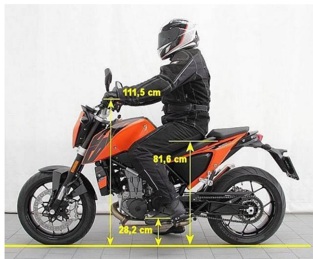
Anordnung von Lenker, Sitzbank und Fußrasten bietet Fahrerinnen/Fahrern unterschiedlicher Größe gute Ergonomie. Lenker und Fußrasten einstellbar
