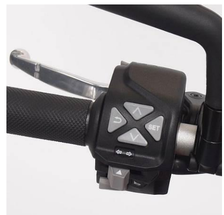
Die vielen Funktionen des Bordcomputers sind intuitiv von der linken Lenkerseite bedienbar.
