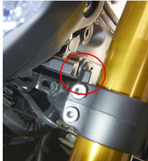
Der Lenkeranschlag darf nicht gebrochen oder verformt sein.
