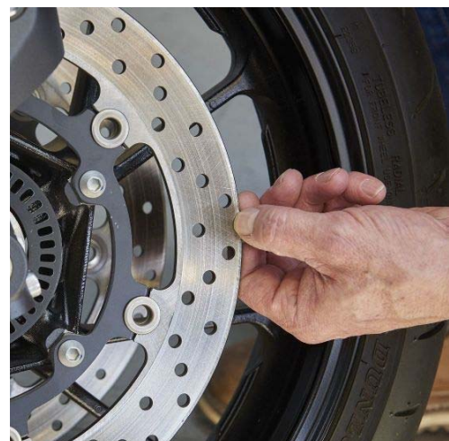
Die Nagelprobe an den Bremsscheiben.
