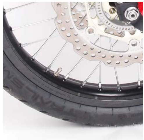
Drahtspeichen genau prüfen. Mit lockeren, fehlenden o. gebrochene Speichen sollte nicht gefahren werden.
