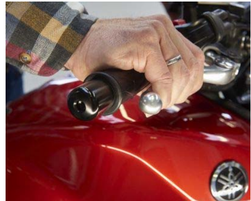
Der Bremsgriff darf sich nicht voll durchziehen lassen.
