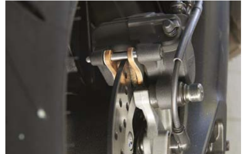
3 mm Stärke sollten die Bremsbeläge noch aufweisen.
