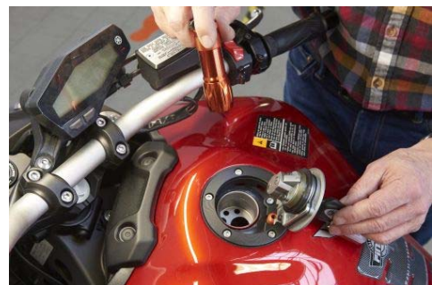
Rost am und im Tank ist nur bei alten Maschinen zu erwarten, wenn sie überwiegend unter freiem Himmel stand.
