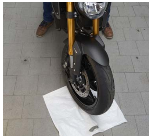
Eine Folie unter dem Vorderrad reduziert die Lenkkräfte. Defekte am Lenkkopflager lassen sich so leichter „erfühlen“.
