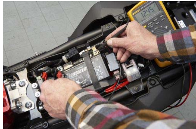
Erst unter Last zeigt die Batterie die inneren Werte
