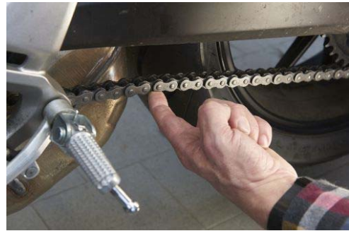
Kettendurchhang immer an verschiedenen Kettenabschnitte prüfen.
