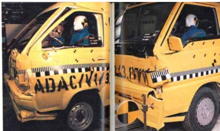
Da 1987 sowohl Mitsubishi für den L300 als auch Toyota für den Lite-Ace mit verbesserter Sicherheit werben, prüft der ADAC dies in eigenen Versuchen nach (Frontalaufprall, starre Wand, 48 km/h, 100 Prozent Überdeckung)
