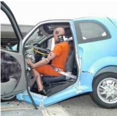
Da ab Februar 2005 Jugendliche ab 16 Jahren den Führerschein der Klasse S erwerben und damit Leichtmobile fahren dürfen, überprüft der ADAC die Sicherheit dieser Fahrzeugklasse. Dazu fährt ein JDM Albizia mit 40 km/h gegen einen gleich schnellen Renault Twingo. Die Insassen des Leichtmobils sind Lebensgefahr ausgesetzt. Durch das vom Gesetzgeber auf 350 Kilogramm limitierte Gewicht ist der JDM nicht stabil genug, um den Insassen Schutz zu bieten.
