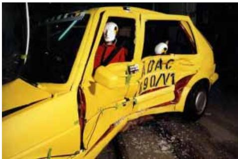
Darüber hinaus wird mit beiden Modellen je ein Seitencrash nach US-Norm und ein Seitencrash nach EG-Vorschlag durchgeführt. Dabei zeigt sich, dass der US-Aufprall geringere Anforderungen an die Fahrzeuge stellt – sowohl Opel als auch VW bestehen ihn knapp. An dem von der EG vorgeschlagenen Versuchsaufbau scheitern jedoch beide Modelle. Da der EG-Vorschlag die strengeren, aber erfüllbaren Anforderungen stellt, wird er ab sofort beim ADAC zum Test-Standard.
