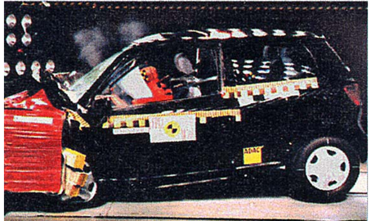
Platt gemacht: Der Vorderwagen hat deutlich Aufprallenergie „vernichtet“, das Passagierabteil bleibt stabil
