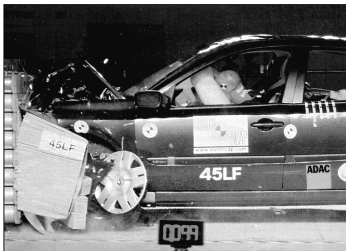
Frontalcrash: Die Fahrgastzelle steht wie eine Burg, das Rückhaltesystem arbeitet perfekt
