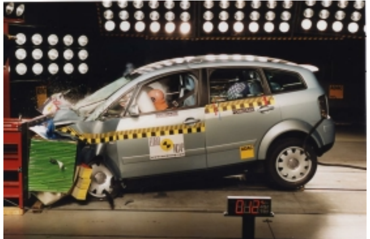
Die Aluminium-Connection: Alu-Auto gegen Alu-Deformationselement (wird vor der Barriere fixiert)
