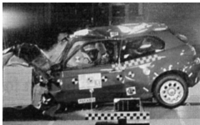
Auch das Bild zeigt deutlich: Den Frontcrash mit 64 km/h verkräftet die Karosserie nicht
