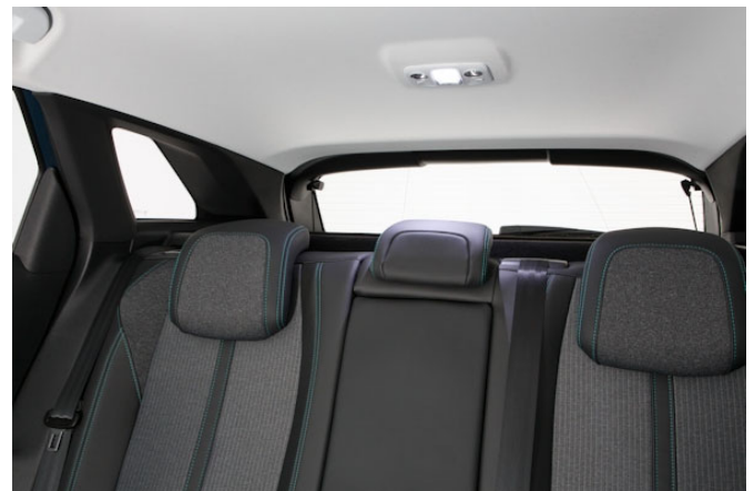
Breite Dachsäulen schränken die Sicht nach hinten ein.
