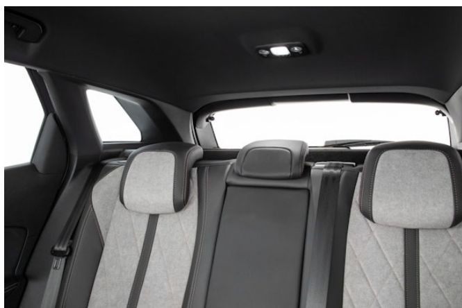
Breite Dachsäulen schränken die Sicht nach hinten ein.
