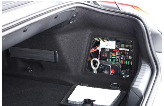
Die Abschleppöse, der Verbandkasten, das Bordwerkzeug und der Sicherungskasten befinden sich unter einer Klappe im Kofferraum.
