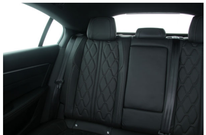
Breite Dachsäulen und nicht versenkbare Fondkopfstützen schränken die Sicht nach hinten erheblich ein.
