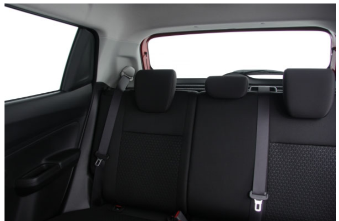
Die breiten Dachsäulen hinten stören bei einer sonst recht guten Rundumsicht. Gut: Die teilversenkbaren Kopfstützen sind außerhalb des Sichtfeldes.
