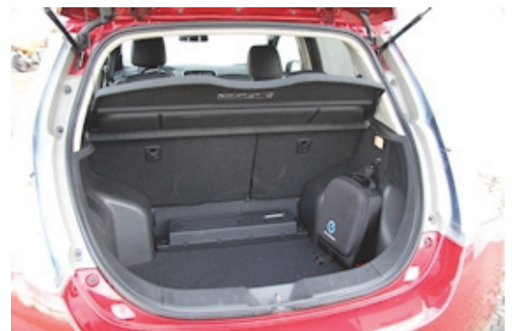
Der Kofferraum konnte beim Facelift um 45 l auf 340 l Volumen erweitert werden.
