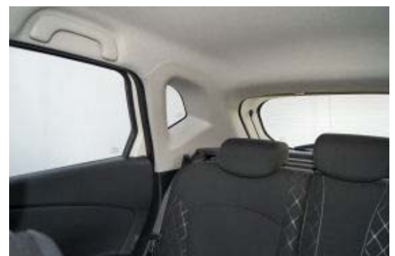
Breite Dachsäulen verhindern eine gute Sicht nach schräg hinten.
