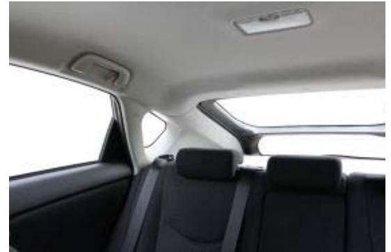
Die breiten Dachsäulen verhindern trotz zusätzlicher Dreiecksfenster die Sicht nach schräg hinten.
