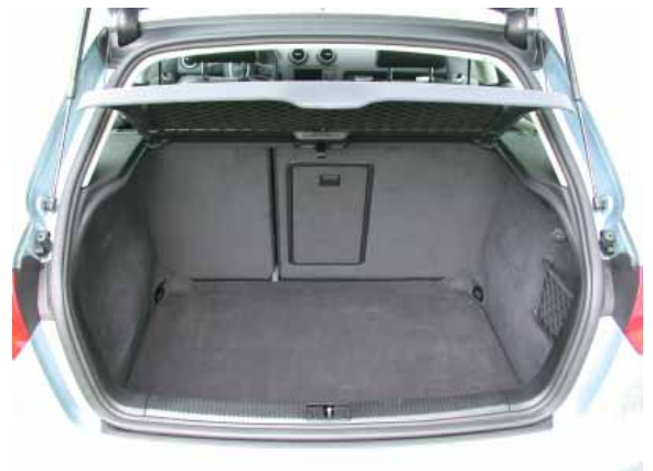
Mit 330 l Volumen ist der Kofferraum um 20 l kleiner als beim Konkurrenten VW Golf.
