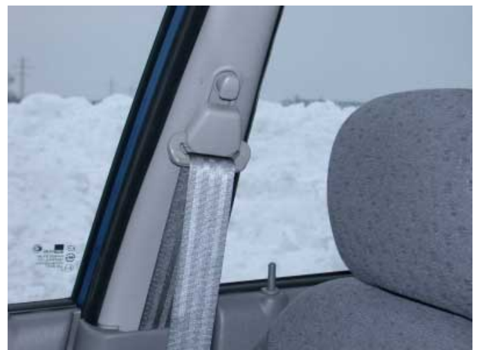
Kantige Gurtbeschläge bedeuten ein erhöhtes Verletzungsrisiko bei einem Seitencrash.
