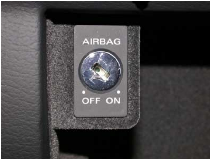
Per Zündschlüssel lassen sich die Airbags auf den Beifahrerplatz deaktivieren. Damit können auch auf diesem Platz rückwärtsgerichtete Kinderrückhaltesysteme verwendet werden.
