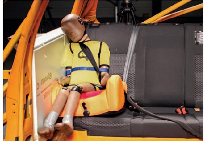
ADAC Crashversuch: Dummy mit Sitzerhöher bei einem Seitencrash: Kopf und Körper des Dummies schlagen ungeschützt an die Fahrzeugseitenwand.
