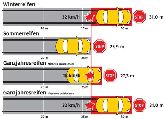
„Sommerreifen bremsen auf trockener Fahrbahn am besten.“
