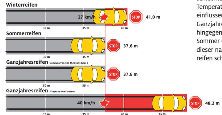
Fast 11 m Bremsweg liegen zwischen dem besten und dem schlechtesten Ganzjahresreifen. Temperaturunterschiede beeinflussen den Bremsweg der Ganzjahresreifen kaum. Wird hingegen ein Winterreifen im Sommer eingesetzt, stoppt dieser nach 41 m, ein Sommerreifen schon nach 37,6 m.
