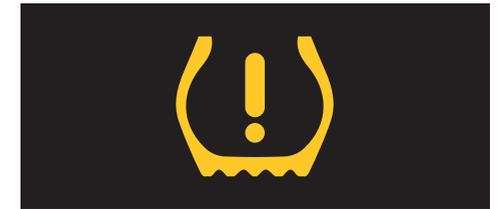
Beispielanzeige eines indirekt oder direkt messenden Systems.
