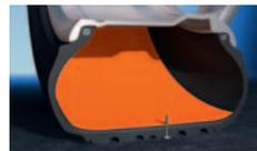
Bei der Seal-Technologie wird dafür gesorgt, dass eine Verletzung in der Reifenlauffläche gar nicht erst zum Luftdruckverlust führt. Durch ein Versiegelungsmittel wird die Reifenlauffläche provisorisch abgedichtet, um den Druckverlust, etwa aufgrund eines Nagels, zu verhindern. Seal-Reifen sind mit allen handelsüblichen Felgen kompatibel und mit einem entsprechenden Symbol gekennzeichnet.
