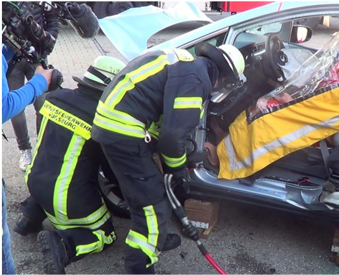
Abb. 5: Durchtrennen der A-Säule mit hydraulischer Schere
