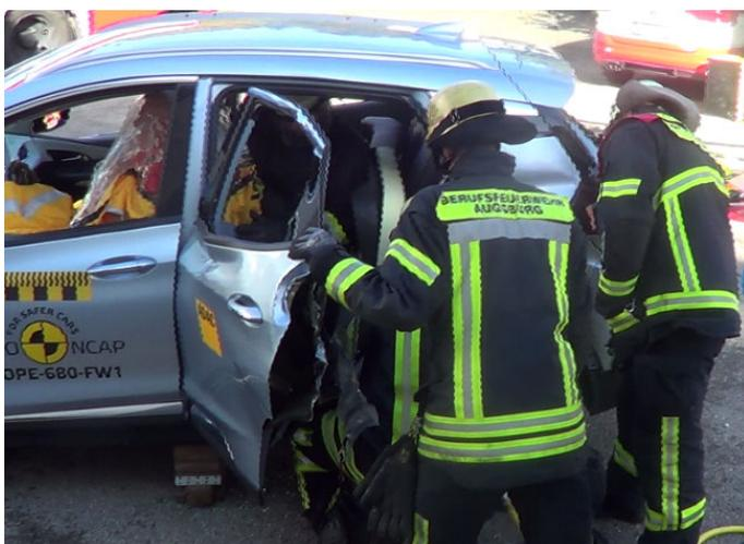
Abb. 1: Entfernen der Türen für eine große Seitenöffnung, beginnend am Heck.
