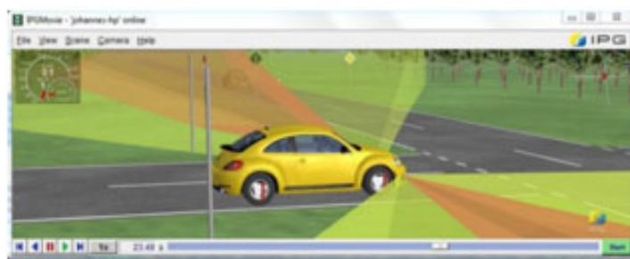
Bild 11: Simulation von Kreuzungssituationen mittels IPG CarMaker
