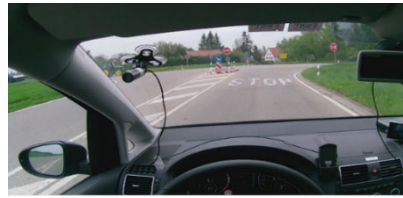
Bild 4: Einfluss der Körpergröße bei der Sicht nach vorn
