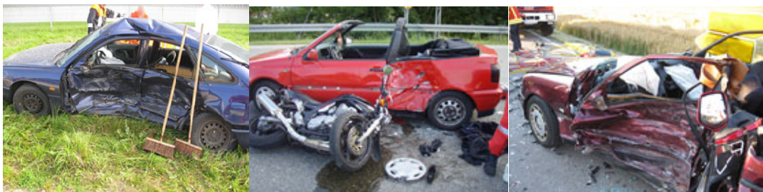
Bild 2: Seitenaufprall Pkw/Pkw und Pkw/Motorrad
