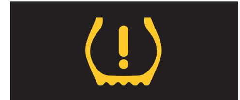
Beispielanzeige eines indirekt oder direkt messenden Systems.
