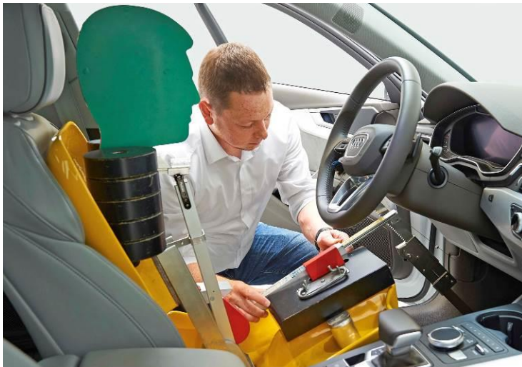
Messpuppe zu Ermittlung der Innenraummaße
