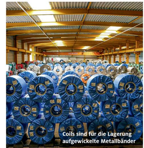
Coils sind für die Lagerung aufgewickelte Metallbänder
