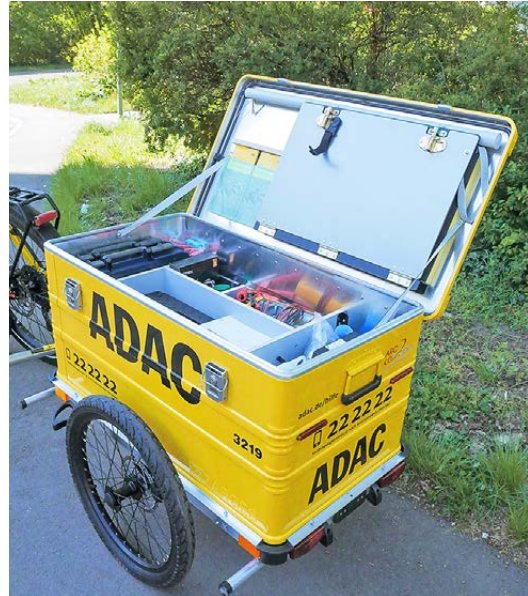
Der Fahrradanhänger wiegt knapp 80 kg. Außer Ersatzbatterien und -rädern ist darin alles enthalten, was ein Gelber Engel benötigt, um ein Auto wieder flottzumachen
