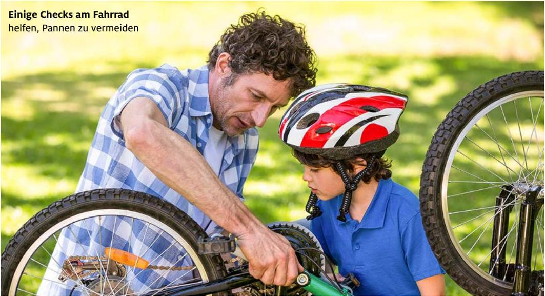
» **Sauberkeit:** Keinen Hochdruckreiniger nutzen, denn dieser spült Schmierstoffe aus dem Antrieb und kann die empfindlichen Lager, Kontakte und die Kette schädigen. Groben Schmutz mit einer Bürste entfernen, den Rest mit einem Lappen säubern. Anschließend die beweglichen Teile des Rades einfetten.
