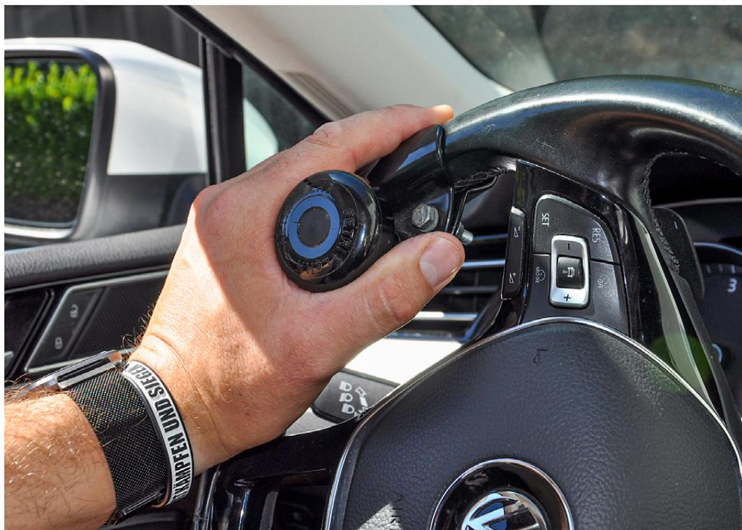
**Der Knauf am Lenkrad ist das Einzige,** was heute vom Autoubau noch übrig ist. Das Automatikgetriebe kann inzwischen standardmäßig bestellt werden, der automatische Regensensor macht einen Hebelumbau überflüssig. Andere dürfen aus Sicherheitsgründen nicht mit dem Knauf fahren, daher ist er abnehmbar
