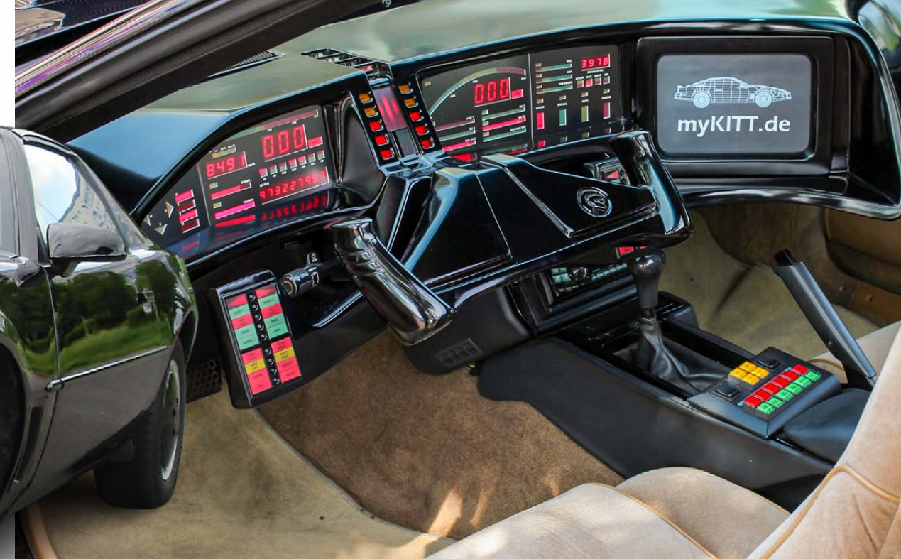
Originalgetreues Cockpit Über die Analoginstrumente sind die futuristischen Anzeigen aus der Serie gebaut. Mit dem TÜV gibt es hierbei keine Probleme. Das Lenkrad muss allerdings gegen ein rundes Exemplar getauscht werden
