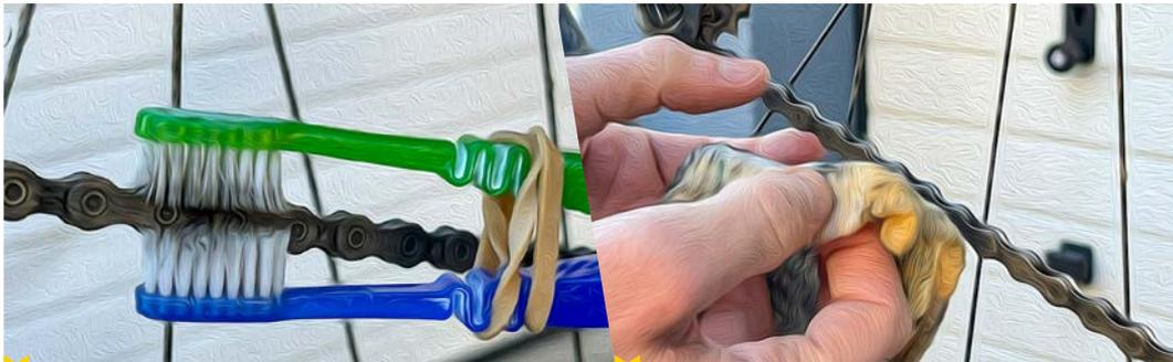
Schieben Sie die Fahrradkette zwischen die beiden Bürstenköpfe und lassen Sie die Kette mehrmals durchlaufen. So entfernen Sie gleichzeitig den Dreck außen an der Kette sowie zwischen den Kettengliedern.
