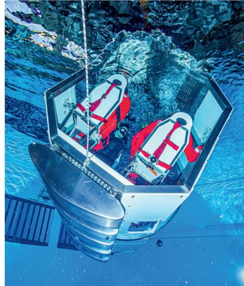
**Die Kapsel kann sich unter Wasser um ihre eigene Achse drehen**, damit wird das Umkippen des Hubschraubers unter Wasser simuliert
