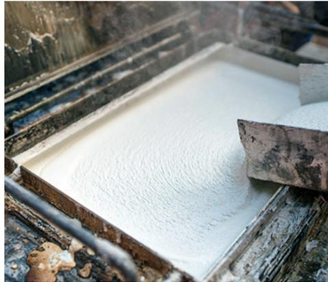
**Eiltempo** Bei der Farbe handelt es sich um Heißspritzplastik, kurz „HSP“ – und es trocknet innerhalb von fünf Minuten
