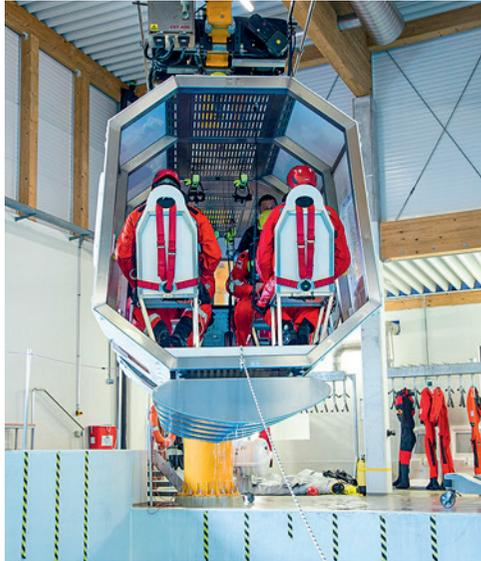
**Die Hubschrauberzelle wurde für das Wassertraining nachgebaut** Mit einem Kran wird sie in Position gebracht
