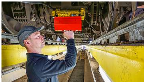
Unter die Räder gelaufen Mit einem Magneten testet Henrik den Auslöser für eine Zwangsbremse
