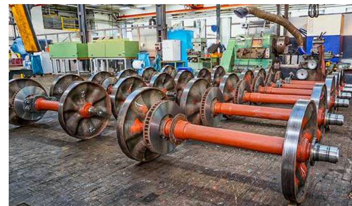
Aufgereiht Die erneuerten Achsen warten in der Fabrikhalle auf den Einbau in die Drehgestelle
