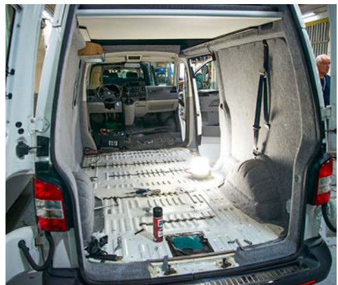
Leerstunde Die Vans werden vor dem Ausbau komplett gestrippt
