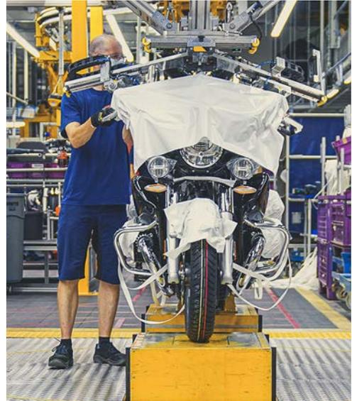
„Speicherstrecke“ genutzt, um die Stränge A und B voneinander unabhängig zu machen. Dann geht es im Obergeschoss weiter. Immer mehr Kabel werden verlegt. Schließlich folgt der Tank, dessen Linierung bei BMW auch im Jahr 2021 traditionell von Hand gezogen wird. Kurze Zeit später wird die Elektrik aktiviert. Die Endmontage beschließen Sitzbank, Cockpit und Auspuff. Keine Frage, auch hier ist eine Endkontrolle Pflicht.
