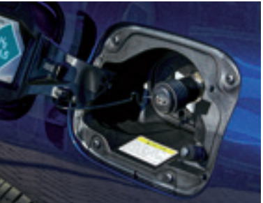
Sicherheit an der Zapfsäule: Etwa 122 Liter oder fünf Kilogramm Wasserstoff passen in den Tank eines Toyota Mirai bei 700 bar Druck. Beim Betanken garantiert eine mechanische Vorrichtung die optimale Kupplung zwischen Einfüllstutzen und Fahrzeug
