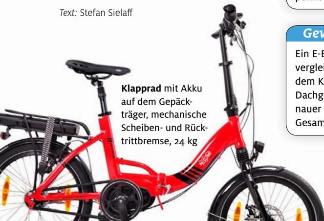
**Klapprad** mit Akku auf dem Gepäckträger, mechanische Scheiben- und Rücktrittbremse, 24 kg
