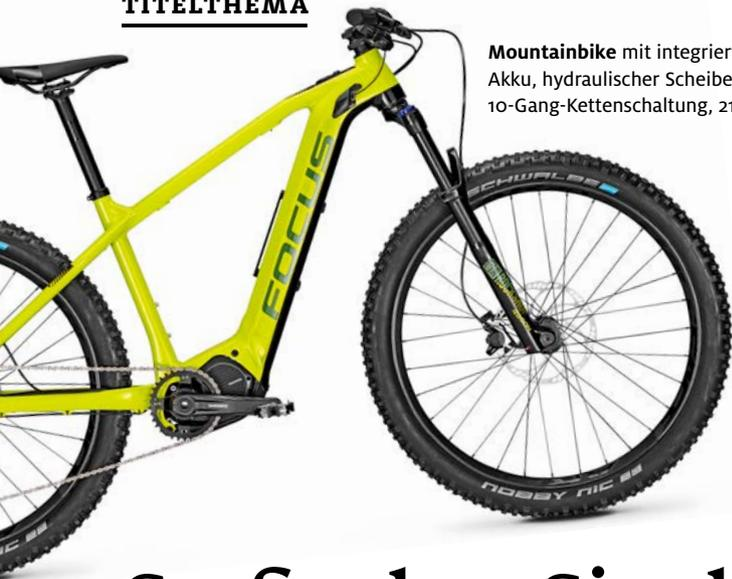
**Mountainbike** mit integriertem Akku, hydraulischer Scheibenbremse, 10-Gang-Kettenschaltung, 21 kg
