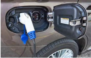
**Steckdose:** Seine 13,8-kWh-Batterie kann extern geladen werden. Trotz vieler Tasten ist das Cockpit übersichtlich
