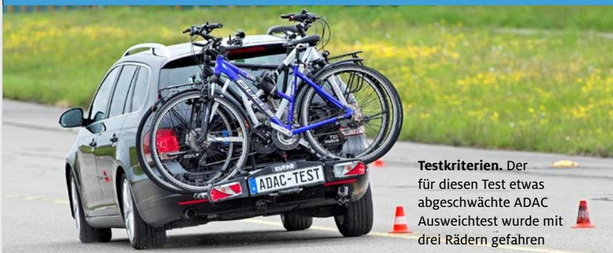
**Testkriterien.** Der für diesen Test etwas abgeschwächte ADAC Ausweichtest wurde mit drei Rädern gefahren
