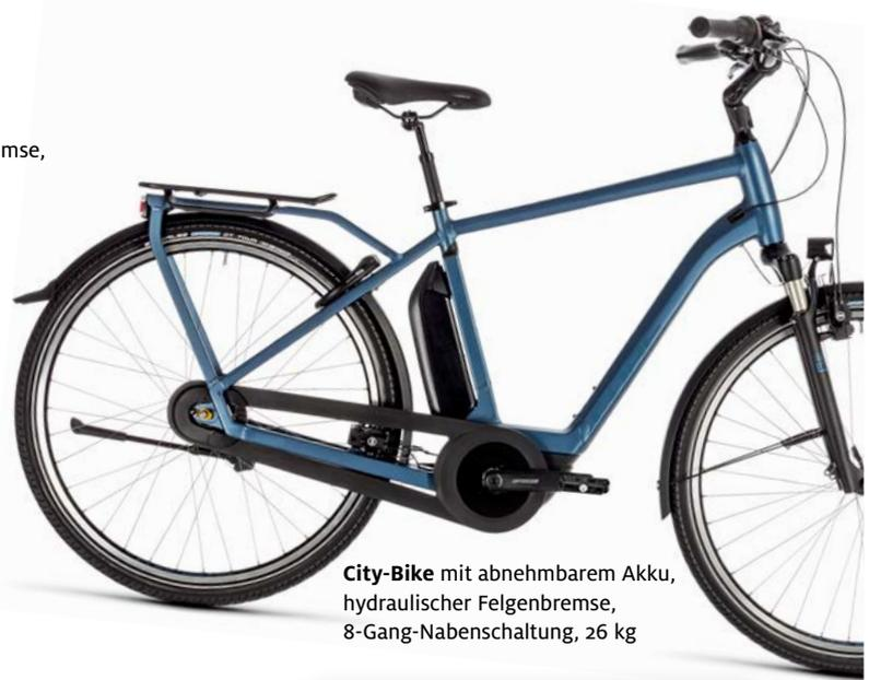
**City-Bike** mit abnehmbarem Akku, hydraulischer Felgenbremse, 8-Gang-Nabenschaltung, 26 kg
